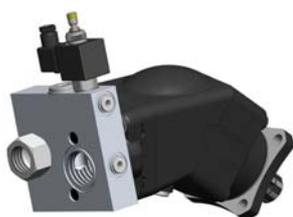
La valvola by-pass viene utilizzata unitamente alle pompe a pistoni Bent Axis **HDS-HDT**. Svolge la funzione di ricircolare parzialmente il flusso di olio. E’ composta da un **corpo in alluminio** montato al corpo posteriore della pompa tramite 2 viti di fissaggio e una vite perno che funge anche da raccordo di mandata, da **una elettrovalvola normalmente aperta che pilota un cursore interno**.
