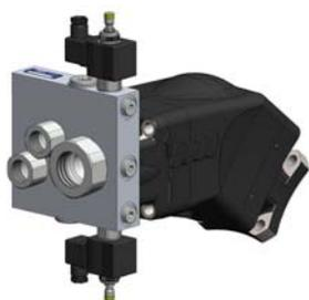
La valvola by-pass viene utilizzata unitamente alle pompe a pistoni Bent Axis **TWIN-FLOW**. Svolge la funzione di ricircolare, **per ogni mandata**, parzialmente il flusso di olio. E’ composta da un **corpo in alluminio** montato al corpo posteriore della pompa tramite **3 viti perno che fungono da raccordi di aspirazione e di mandata**, da **2 elettrovalvole normalmente aperte che pilotano 2 cursori interni**.
